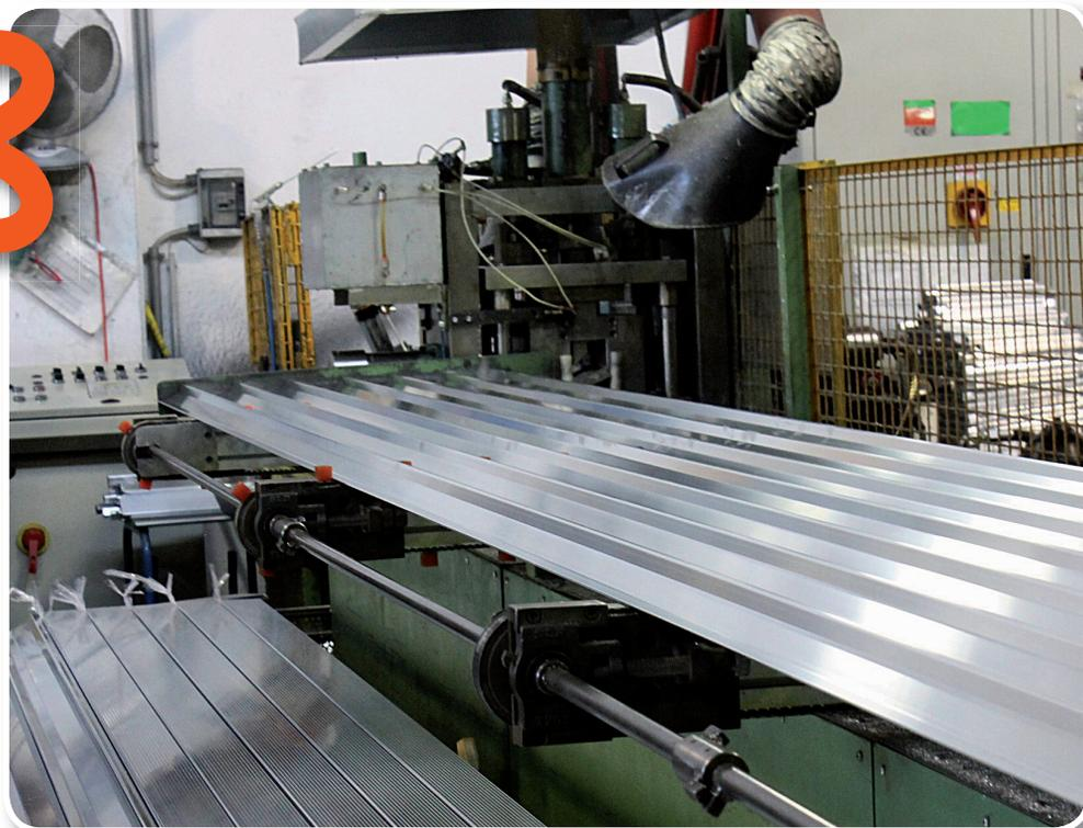
I profilati dei montanti raggiungono la postazione robotizzata a controllo numerico di taglio e foratura. Dei pistoni idraulici provvedono a realizzare automaticamente nel profilo gli alloggiamenti necessari ai gradini.
