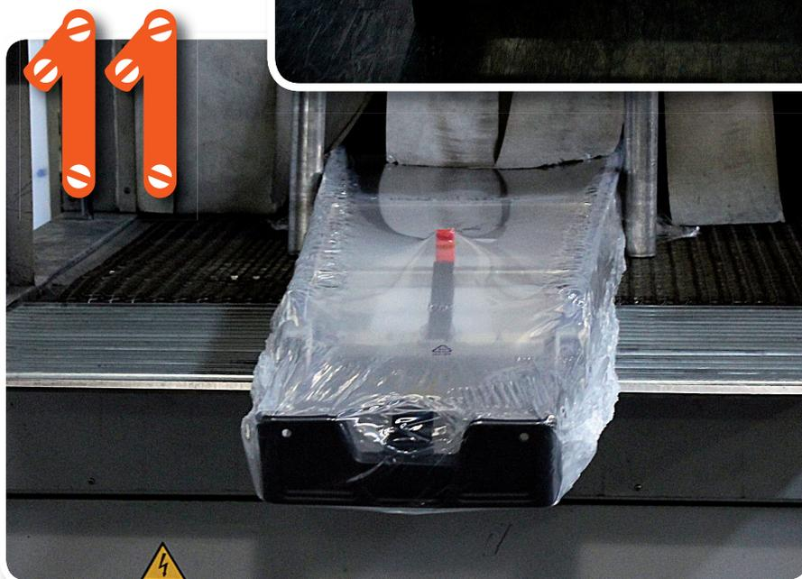
Ad una ad una le scale vengono appoggiate su un nastro trasportatore che le fa scorrere all'interno di una pellicola di film termoretraibile. Così ricoperte passano attraverso un forno, e quando ne escono, grazie allo sbalzo di temperatura, sono perfettamente ricoperte e protette, pronte per il trasporto e la commercializzazione.
